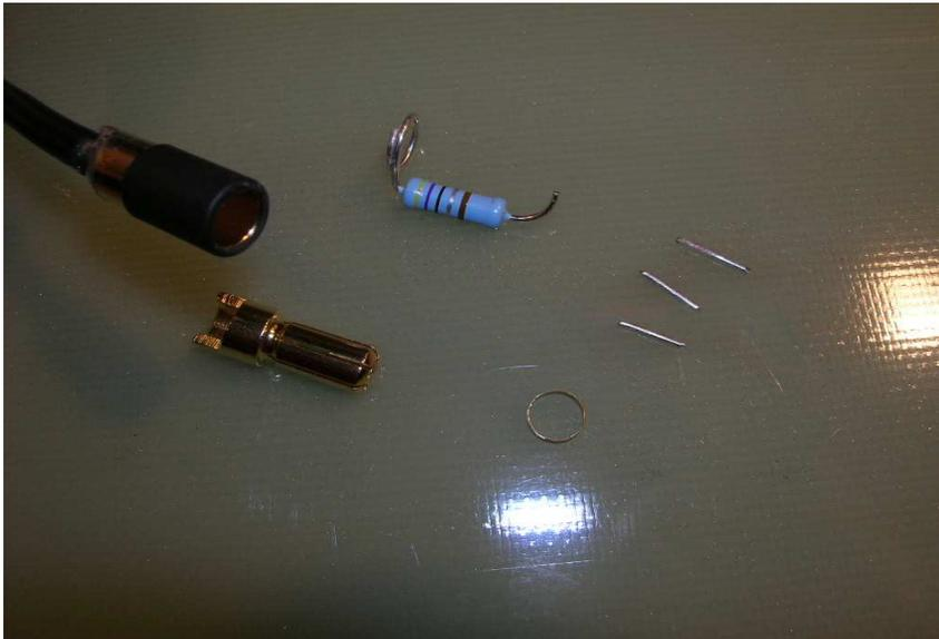
**2.) An die Goldkontaktbuchse des Reglers (bei meinem Beispiel der schwarze Minuskontakt) wird ein Schrumpfschlauch angebracht. Hierbei ist darauf zu achten dass der Schrumpfschlauch die Buchse vorne umschließt, jedoch nicht in die Öffnung hineinragt.**
